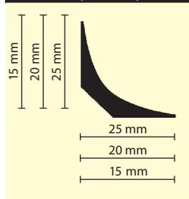
Remontée en plinthe en plastique, dans les dimensions 15 x 15, 20 x 20 et 25 x 25 mm, pour un préformage propre de finition de sol / de mur avec revêtements de plancher débordant sur le mur.
